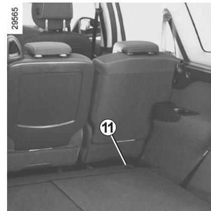
A seconda del veicolo dovete rimuovere gli anelli di fissaggio **11** prima di installare una rete di separazione dei bagagli.
